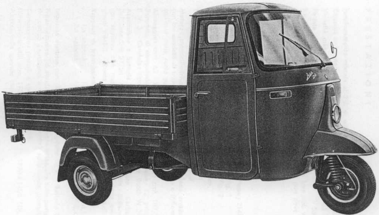
Fig. 2 - Motocarro con pianale e cabina - Pianale di dimensioni utili mm. 1950 x 1400
